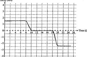
b. i.  $a_{avg} = \Delta v/\Delta t = (0 - 1.5 \text{ m/s})/(2 \text{ s}) = -0.75 \text{ m/s}^2$
